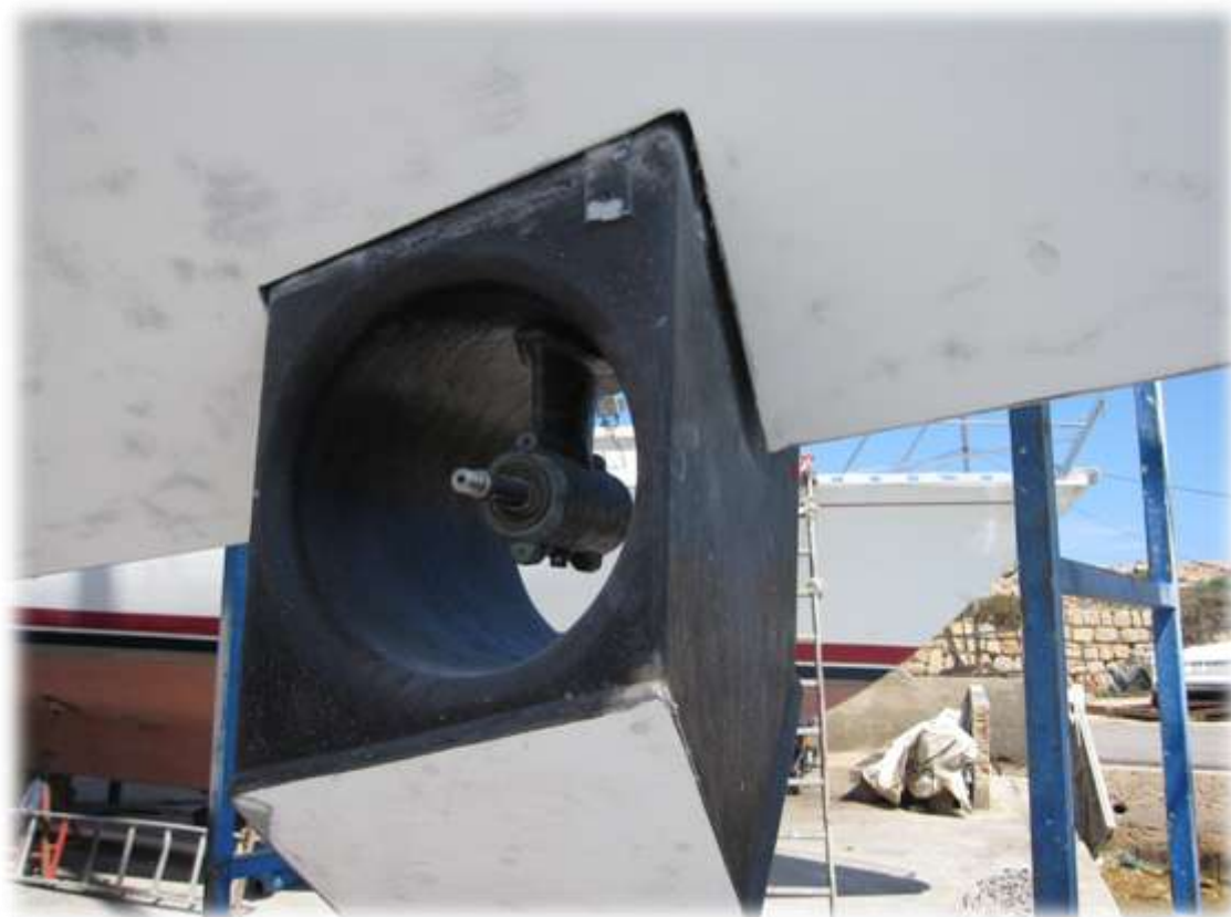
Le propulseur est prêt pour recevoir sa mixture « alcool 90°/silicone »
