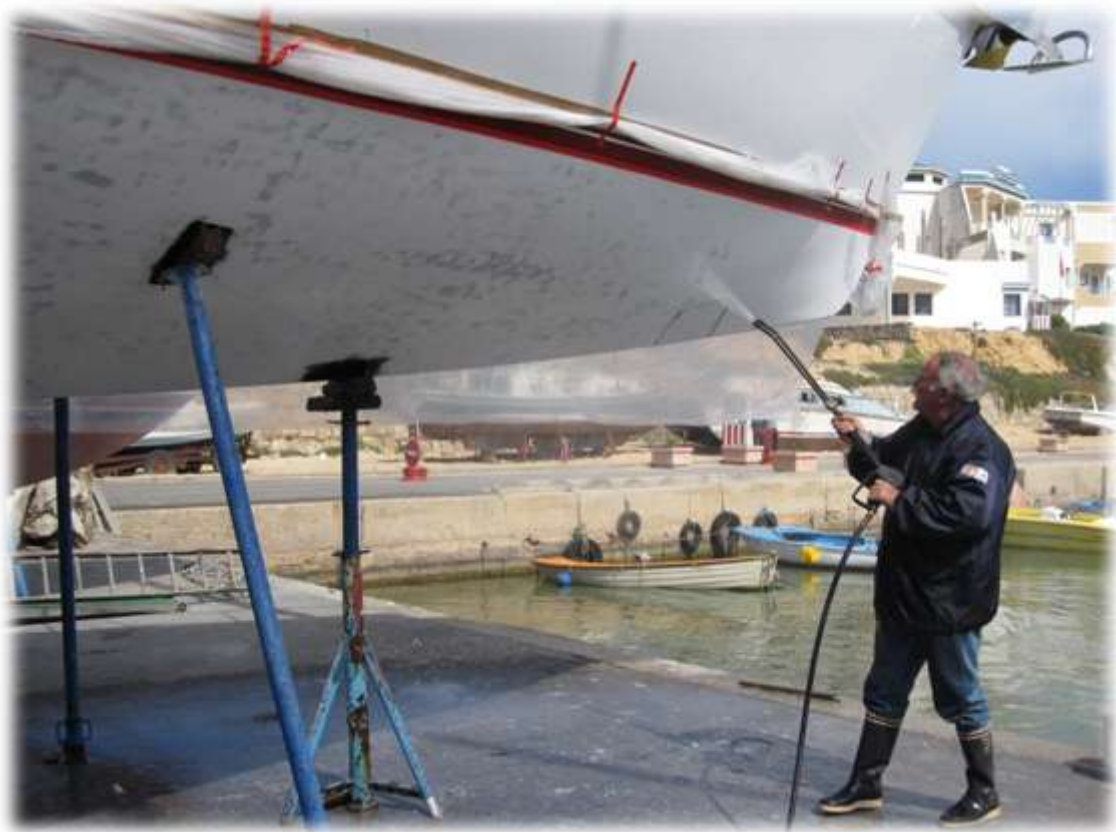
Un coup de jet d'eau pour nettoyer la coque, ensuite nettoyage avec de l'alcool à 90° pour un séchage plus rapide
