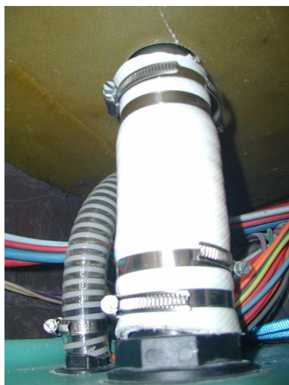
Photos 12 et 13 : Détail du raccord de vidange vers le nable de passavant (à gauche) et de la conduite d'évent vers la coque (à droite).
