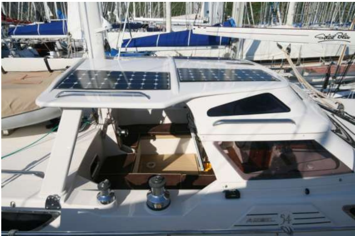
Les panneaux solaires sont intégrés dans la structure et la main courante supplémentaire facilite le passage
