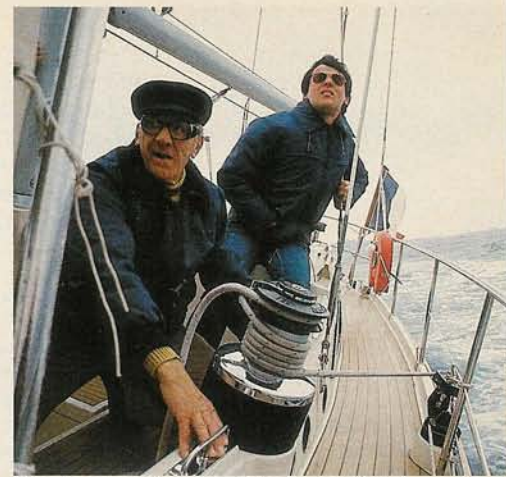
Pour border le foc ou régler la position du chariot sur le rail, il suffit d'appuyer sur un bouton.
