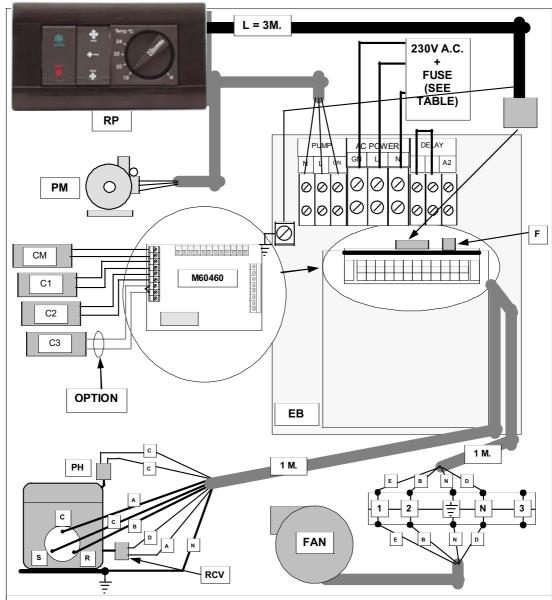
CM = FAN RUN CAPACITOR - CONDENSATEUR DE MARCHE VENTILATEUR - CONDENSATORE DI MARCIA VENTILATORE
