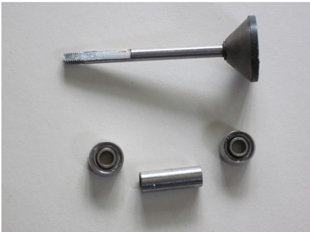
Le remontage nécessite du soin car le fait de pousser le roulement interne dans son logement en plastique en appuyant sur l'aimant risquerait de le briser car l'aimant est fragile.
