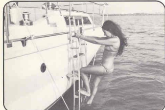
Un simple pivotement, l'échelle de bain est en place. Elle s'aménage en passerelle.
