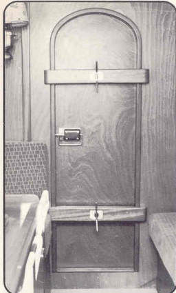
En cas d'abordage, fermez la porte étanche pour gagner le prochain abri.
